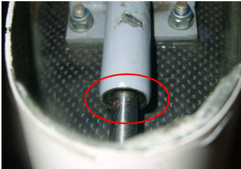
Abbildung / Illustration 1: vorderer HLW-Beschlag (alte Ausführung) / front HT - attachment (old version)
