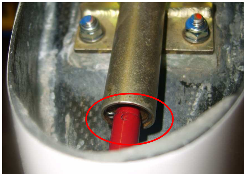
Abbildung / Illustration 2: vorderer HLW-Beschlag 10LS-HV (neue Ausführung) / front HT – attachment 10LS-HV (new version)
